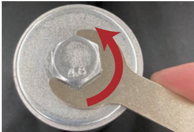
①パイプ底部分にある六角ビスを、付属のオープンレンチ (20mm) を使用して外します。
